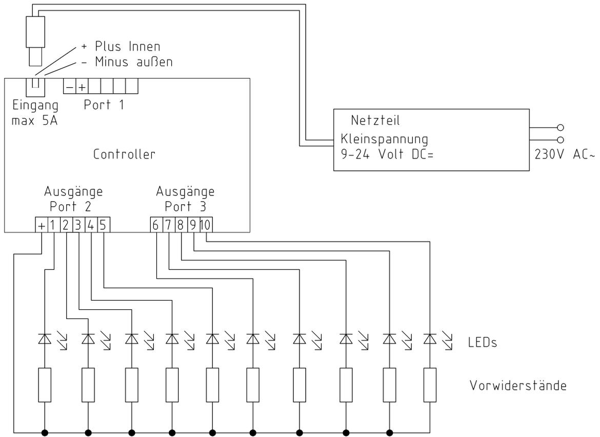
**Anschluss über Klemmleiste, max. 8 A:**
