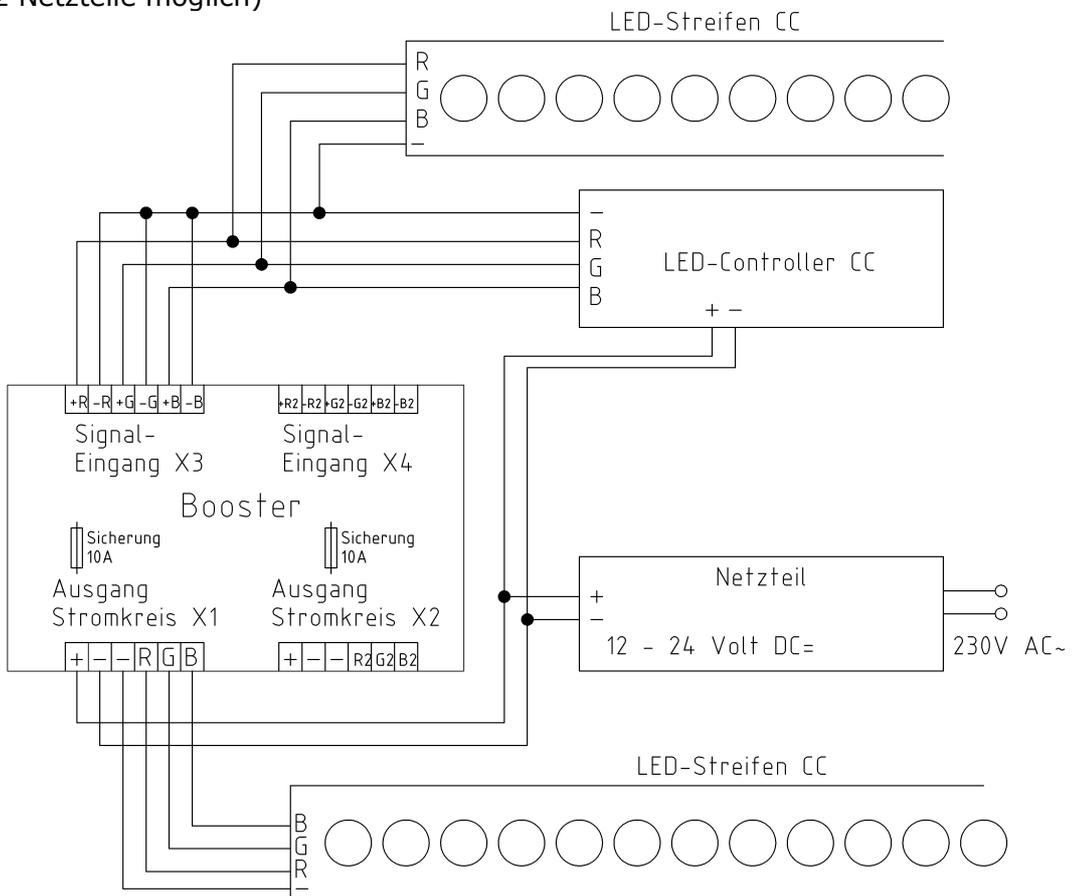
Schaltplan Beispiel C - LED-Streifen CC an Controller CA anschließen, 1 Netzteil:
