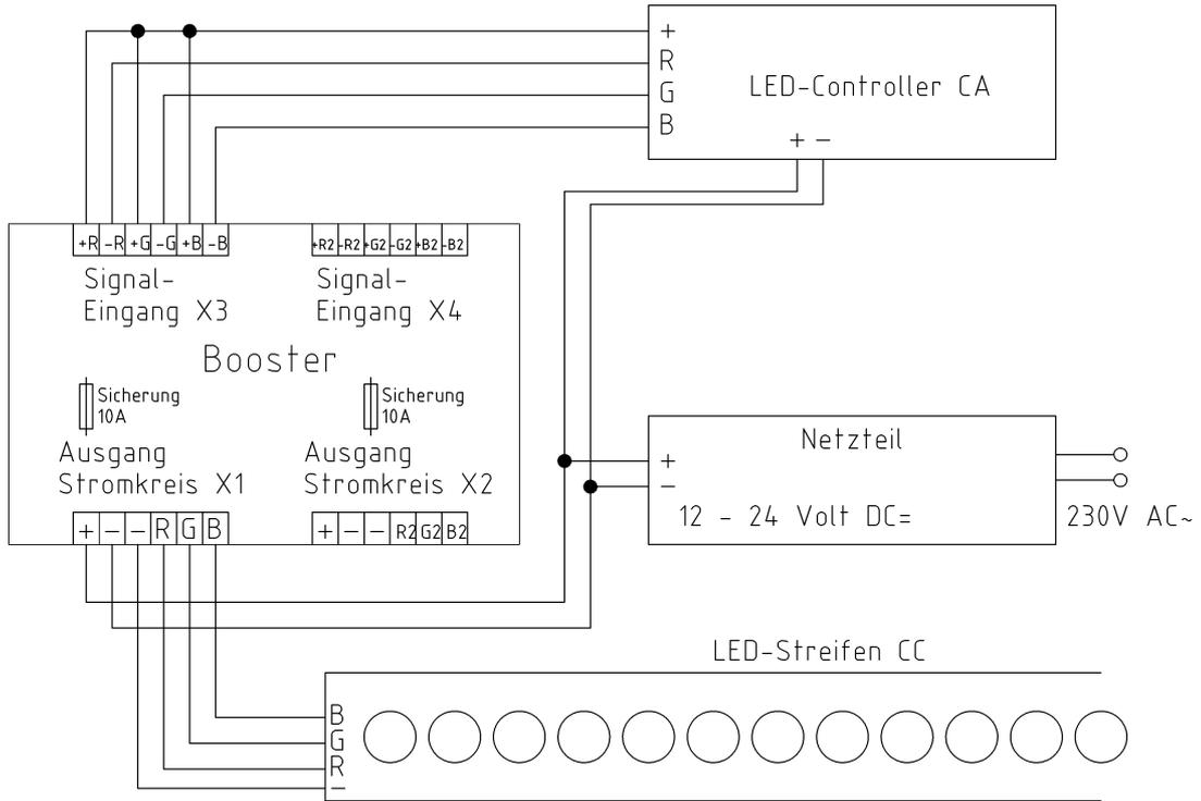
Schaltplan Beispiel D - LED-Streifen RGBW CC an Controller CA anschließen, 1 Netzteil:
