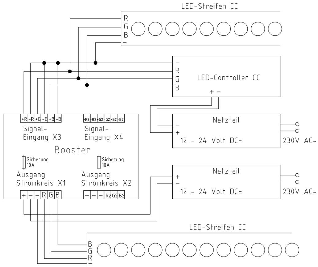
Schaltplan Beispiel B - LED-Streifen CC durch Booster verlängern, 1 Netzteil:
