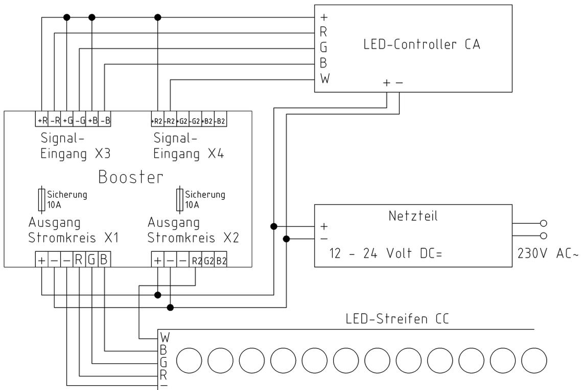
Schaltplan Beispiel F - LED-Streifen CC durch Booster doppelt verlängern, 2 Netzteile:
